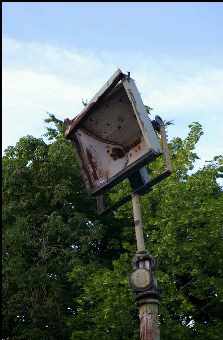
بدنه های آلومینیومی، رنگ به روش آنادایز، سطوح نورگذر پلی کربنات، وزن کم و دیگر تکنیک های ساخت چراغ های LED موجب می شود دیگر مشکل زنگ زدگی، شکستگی و فرسودگی تجهیزات پیش نیاید و شاه چنین صحنه های نا زیبا و پر هزینه نباشیم.
